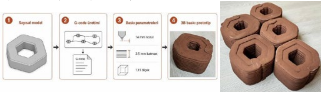
Şekil 4: 3B baskı süreci ve üretilen prototip modüller.
