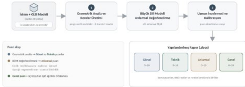
Şekil 2: Üç aşamalı değerlendirme iş akışı: GLB geometrik analizi ve görsel çıktı üretimi, büyük dil modeli anlamsal değerlendirmesi, uzman incelemesi ve rapor çıktısı.
