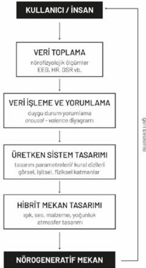
Şekil 2: Nörogeneratif sistem iş akış diyagramı.
